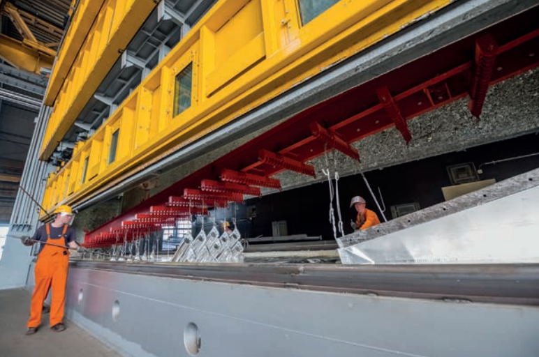
Fot. 2. Wymiary nominalne wanny o wydajności 20 Mg/h: 14,0 × 1,4 × 3,2 (długość × szerokość × głębokość w metrach)
